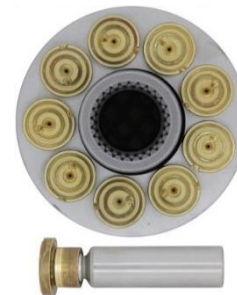
Pistão e sapata no final do teste de campo de 2 anos
