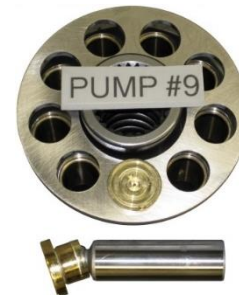
Pistão e sapata no início do teste de campo de 2 anos
