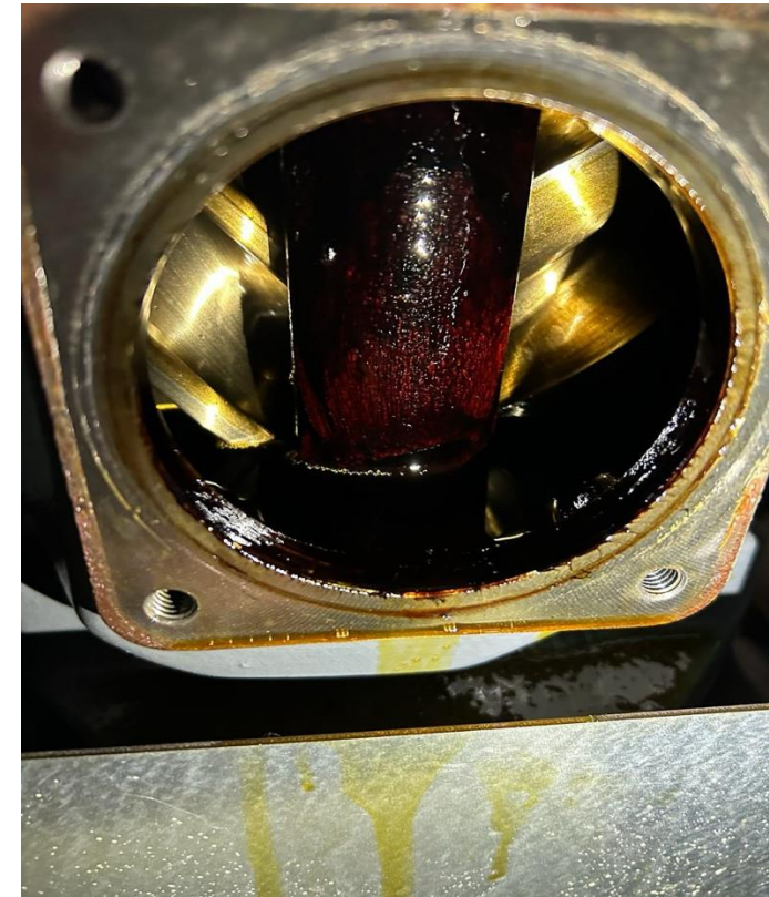
Elemento do compressor com verniz
