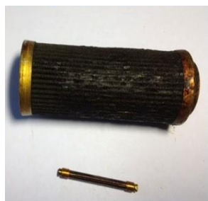
Entupimento de filtros
