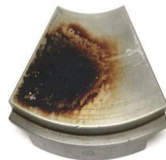
Falha de rolamentos
