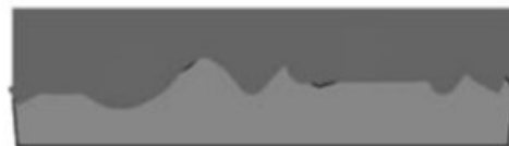
(D) ação contínua de crescimento do tribofilme
