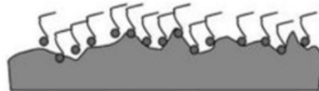
(B) adsorção química ocorrendo na superfície
