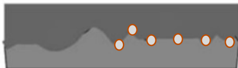
(E) diferença de potencial iniciando corrosão da superfície
