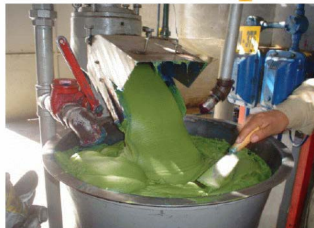
Saída do moinho para a enchimento
