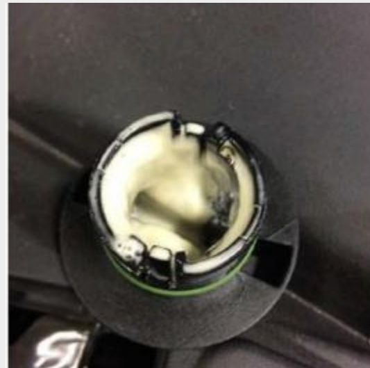
Acúmulo de emulsão sob a tampa de óleo
